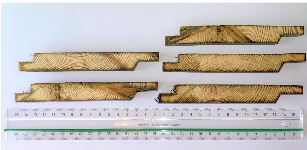
Figur 2-1 Ulike tverrsnitt av royalimpregnert kledningsbord med dobbelfalsprofil. Bildet viser varierende grad av inntrengning av olje med pigment. Dette skyldes varierende tetthet på treet.
