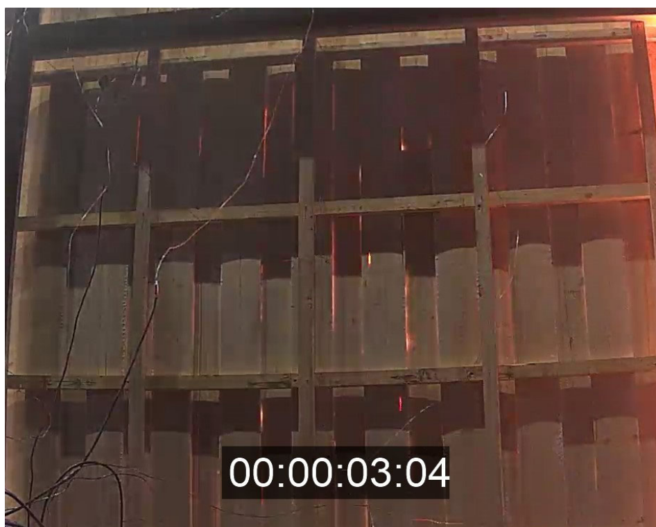
Figur 7-2 Baksiden av tømmermannskledningen i Test 16, 3 sekunder etter teststart.
